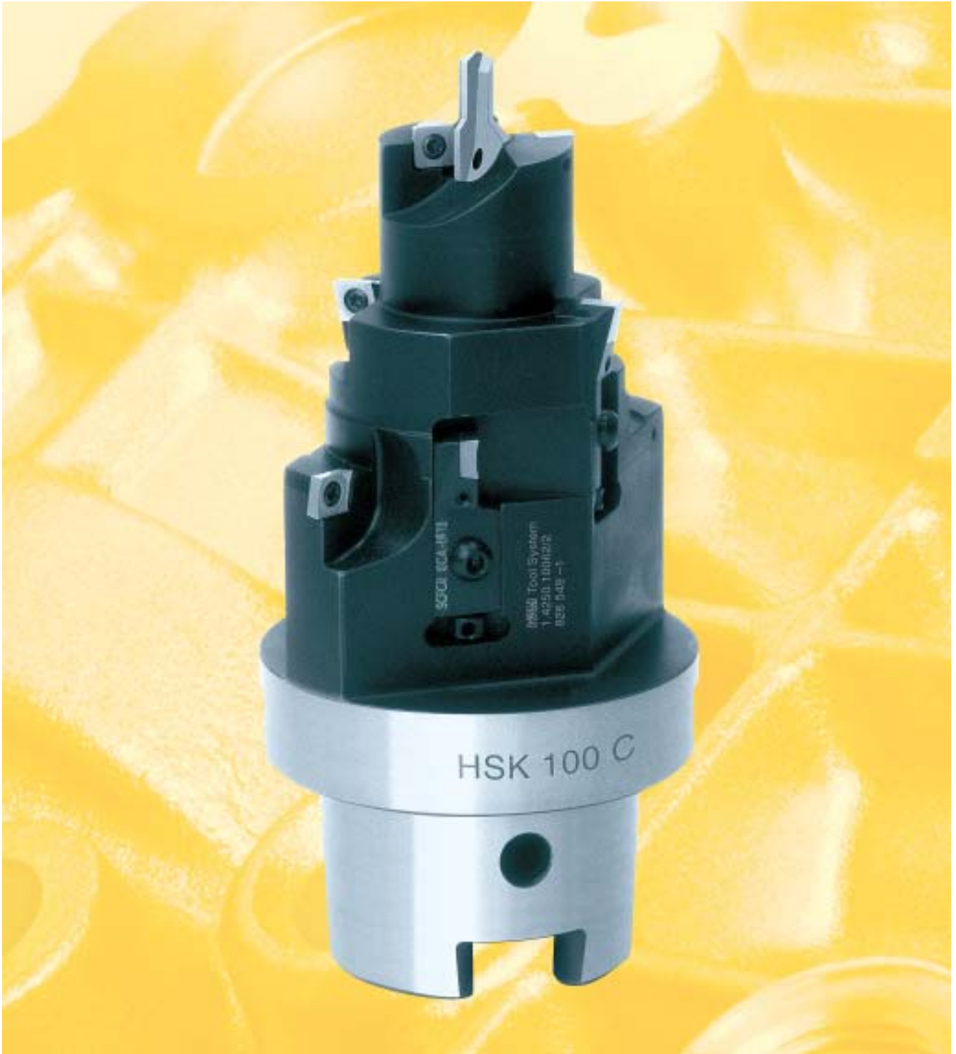
Kombiniertes Bohr-, Senk- und Kassettenwerkzeug mit HSK 100 Vollhartmetall-Stufenbohrwerkzeug mit Comfort-Verstellung System Benz mit Hartmetall- und PKD-Diamant-Schneiden Combined Drill-, Countersinking- and Cartridge Tool with HSK 100 Solid carbide Step Drilling Tool with comfortable adjustment system Benz with carbide- and PCD-diamond-blades
